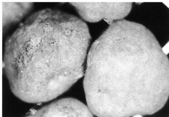
写真4. エコロング (×64) 部分欠落部分拡大
