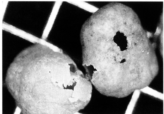
写真 2. エコロング (×20) 亀裂~部分欠落
